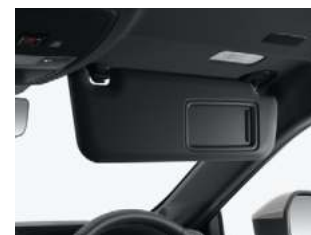
Ⓔ サンバイザー (バニティミラー・LED天井照明・チケットホルダー付)
